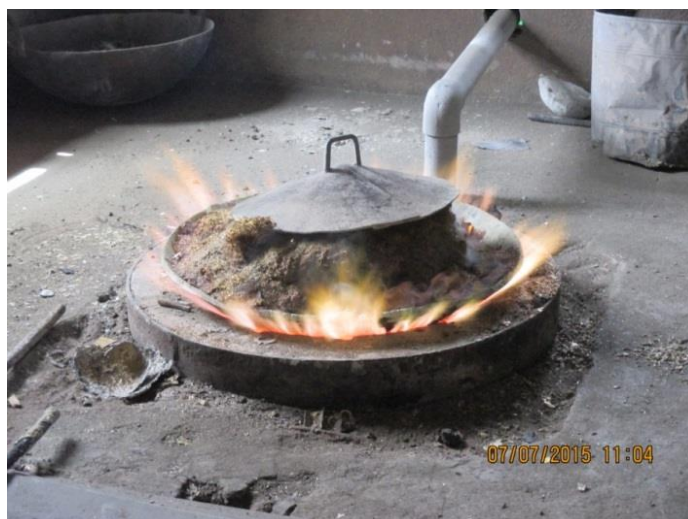
Figure 2.19 a: Actual coke fired pit furnace
